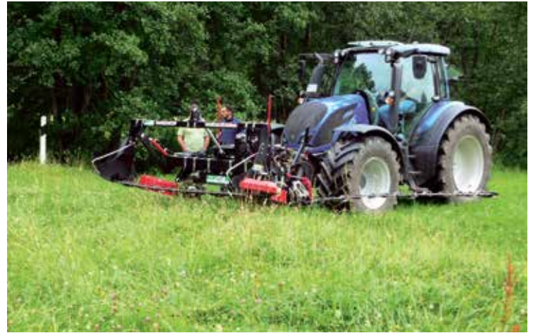
Ein Messermähwerk schont die Insekten – im Gegensatz zum Kreiselmäher
