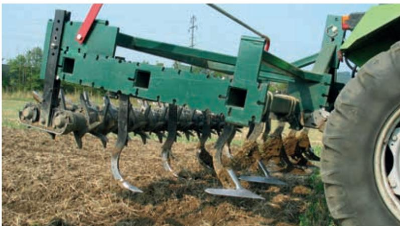
Mit einem ganzflächig unterscheidenden Flachgrubber kann ein ähnlich gutes Resultat gegen Wurzelunkräuter erzielt werden wie mit dem Stoppelhobel oder dem Schälpflug. Im Gegensatz zum Schälpflug und Stoppelhobel wird der Boden mit dem Flachgrubber nicht gewendet.
