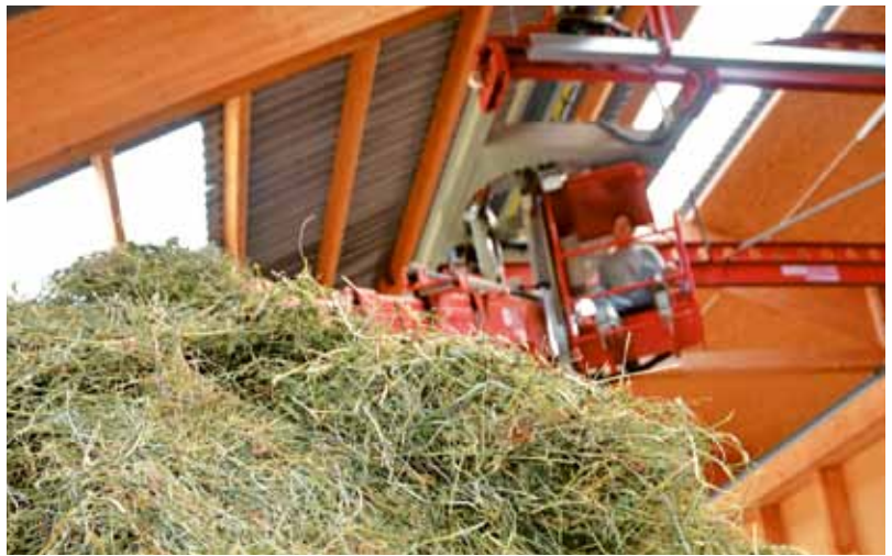
Eine leistungsfähige Heubelüftung trägt in Kombination mit einer Greiferanlage zu einer verlustarmen und qualitätssichernden Heuproduktion bei.
